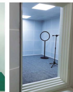
无响室（尺寸：L3W3H2） sound test room,
